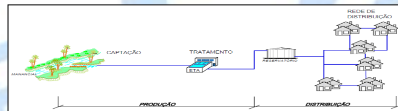
FIGURA 1 – ESQUEMA SIMPLIFICADO DE UM SISTEMA DE ABASTECIMENTO
