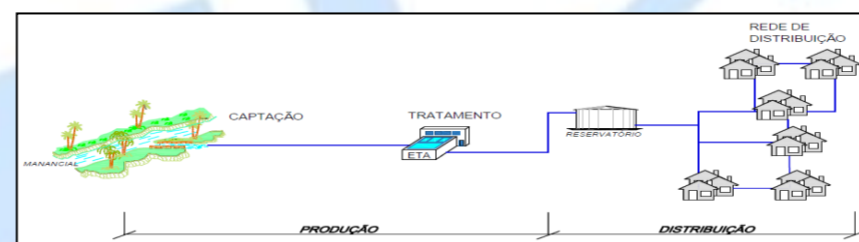
FIGURA 1 – ESQUEMA SIMPLIFICADO DE UM SISTEMA DE ABASTECIMENTO
