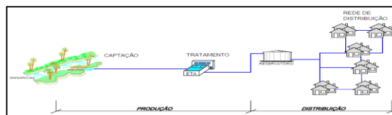
FIGURA 1 - ESQUEMA SIMPLIFICADO DE UM SISTEMA DE ABASTECIMENTO
