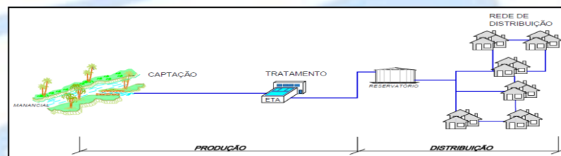
FIGURA 1 – ESQUEMA SIMPLIFICADO DE UM SISTEMA DE ABASTECIMENTO
