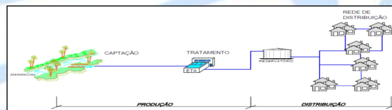
FIGURA 1 – ESQUEMA SIMPLIFICADO DE UM SISTEMA DE ABASTECIMENTO
