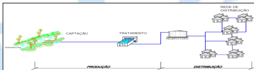
FIGURA 1 – ESQUEMA SIMPLIFICADO DE UM SISTEMA DE ABASTECIMENTO
