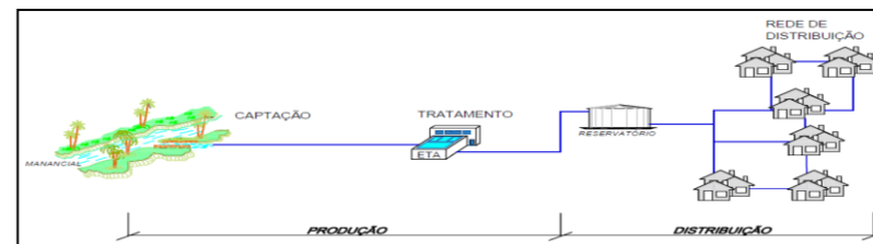
FIGURA 1 – ESQUEMA SIMPLIFICADO DE UM SISTEMA DE ABASTECIMENTO
