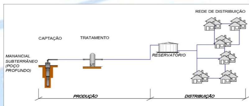
FIGURA 1 – ESQUEMA SIMPLIFICADO DE UM SISTEMA DE ABASTECIMENTO
